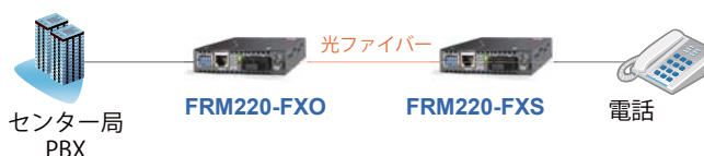
接続例 2: 光ファイバーを介した音声通信 2km \sim 120km
